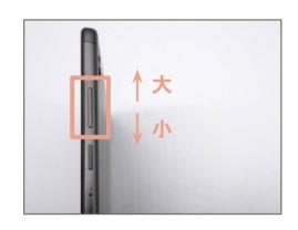
タブレットの側 面にある、大 きなボタンが、 音量を調整す るボタンです。
