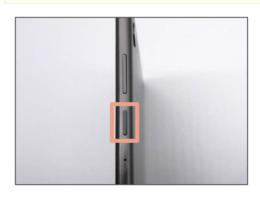
タブレットの側 面にある小さ い方のボタン を軽く押し込み ます。
